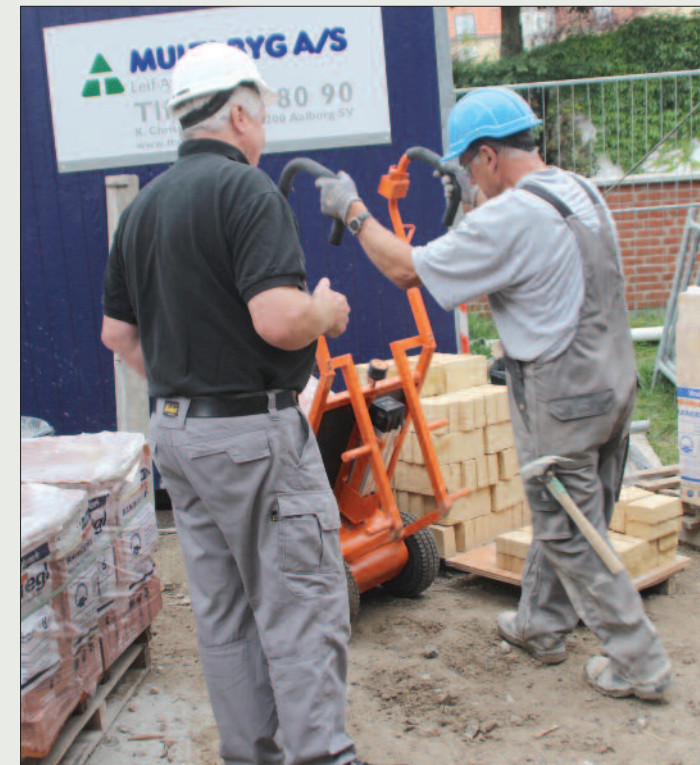
Ikke noget med at vrikke ind under pallen. Kør smartmoveren hen og lad den gøre arbejdet.
